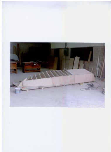
Konstruktionsspannten halb belegt
