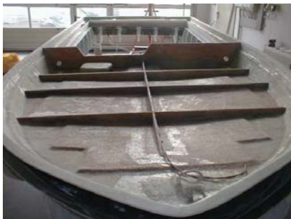
Oberschale mit Holzkonstrukt
