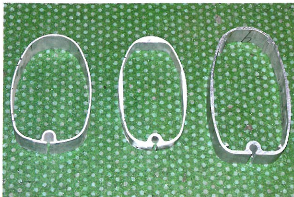
Jüngere Profile fallen länger und schmaler aus. Das Profil in der Mitte verfügt über verstärkte Seiten, was die Steifigkeit erhöht und den Einsatz von Hakenterminals ermöglicht.
