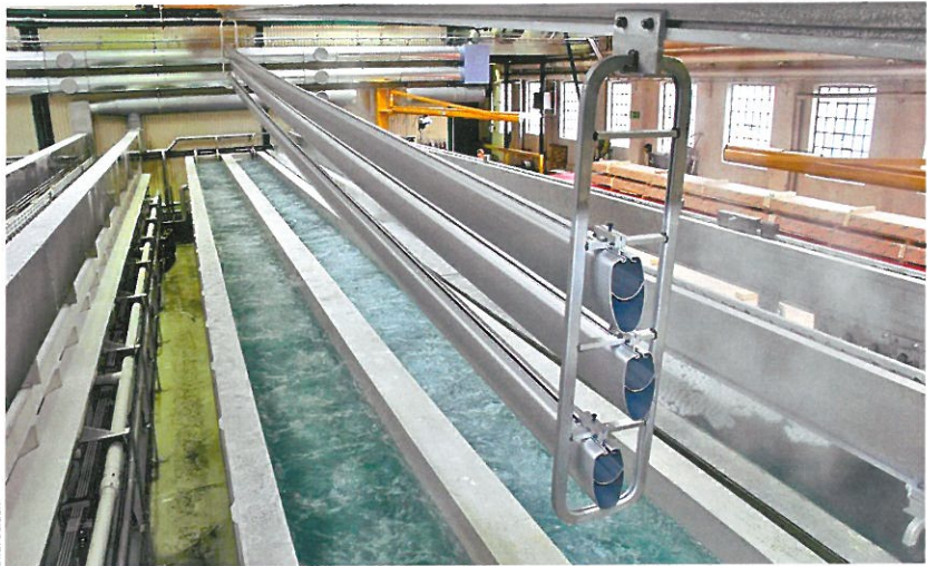
Behandlung von Mastprofilen in einem Eloxalbad: Bei diesem „künstlichen Alterungsprozess“ wird das Material mit einer schützenden Oxidschicht überzogen.
