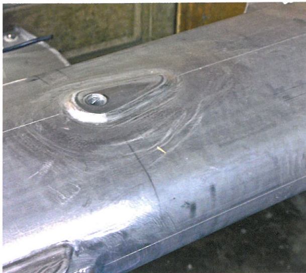
Individueller Mastenbau in Kleinserie: Im Bild ist eine Profildoppelung zur Aufnahme der Wantenkräfte zu sehen. Das Profil wird später entweder lackiert oder pulverbeschichtet.
