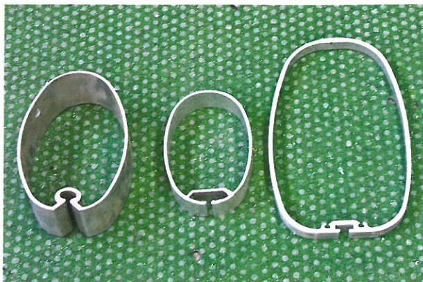
Über lange Zeit wiesen Aluminiummasten vorzugsweise einen ovalen oder tropfenförmigen Querschnitt auf, der für eine relativ geringe Längsstabilität sorgte.
