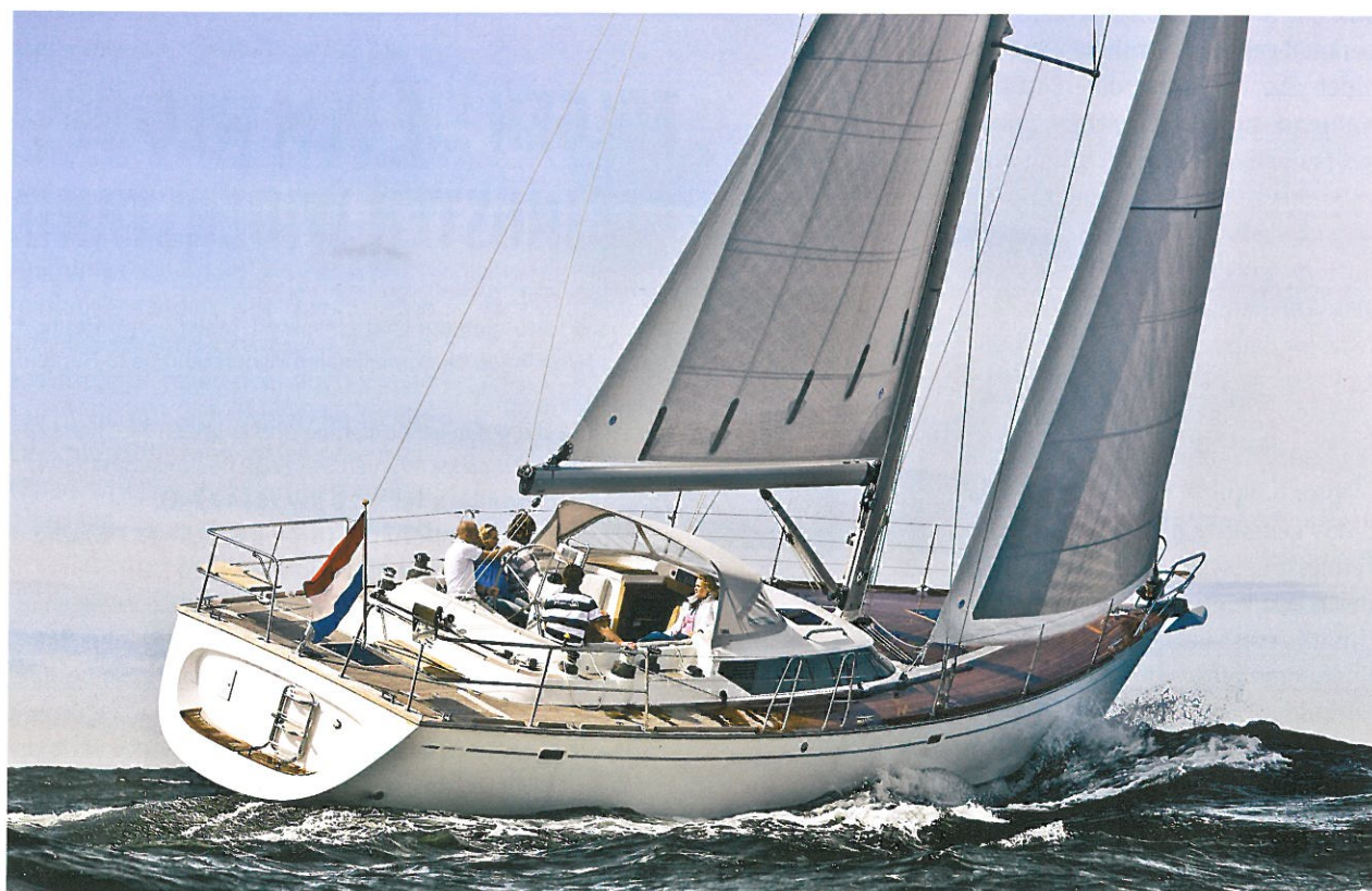
Mittlerweile segeln auch große Fahrtenyachten ohne überlappende Vorsegel, was den Bedienungskomfort des Riggs beträchtlich erhöht. Moderne Mastprofile kommen selbst in dieser Größenordnung ohne Backstagen aus.
