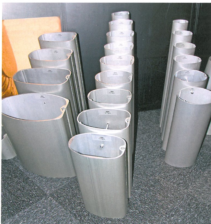
Viele Hersteller führen auch für ältere Boote noch passende Profile im Programm (rechts). In der Mitte und links sind moderne Kasten- und Bullet-Profile aufgereiht (Sortiment von John Mast).
