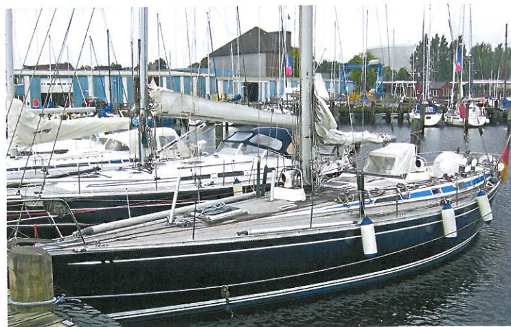
Frühe Aluminiummasten wurden selbst bei größeren Yachten nur mit einem Salingpaar versehen, so dass das Profil einen großen Teil der Kräfte tragen und entsprechend stabil und schwer ausgelegt werden musste.
