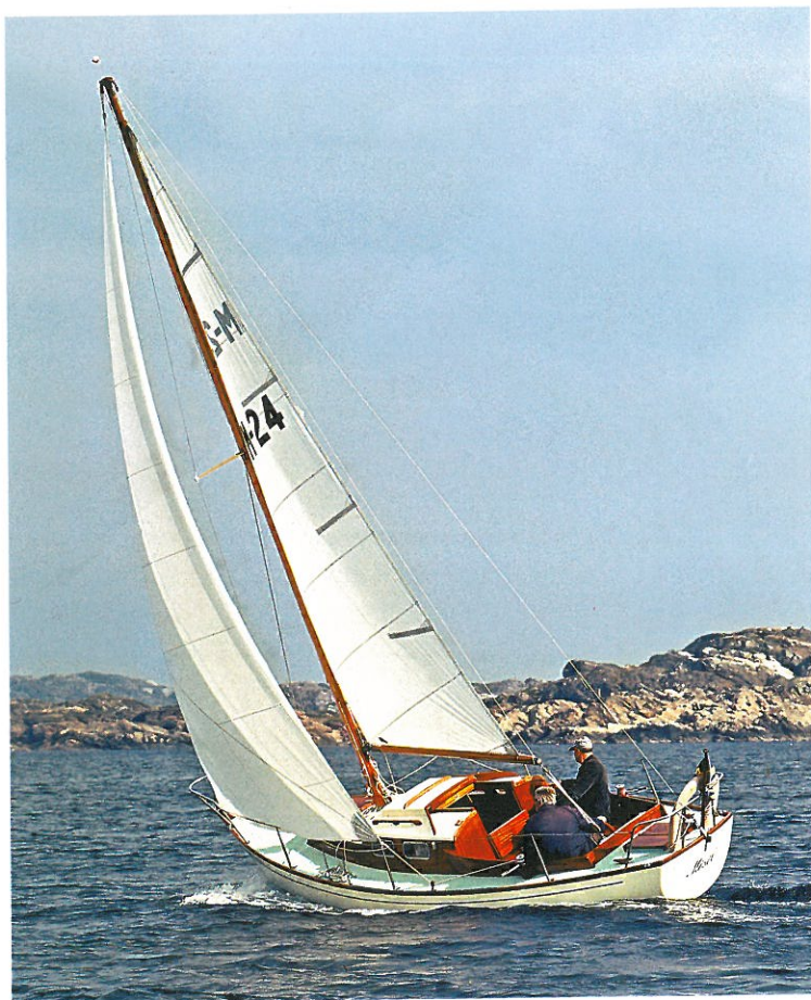
Holz bildete über Jahrhunderte das gebräuchlichste Material im Mastenbau. Erst mit Beginn des Serienyachtbaus wurde es sukzessive von Aluminiumprofilen verdrängt, die sich günstiger produzieren ließen.
