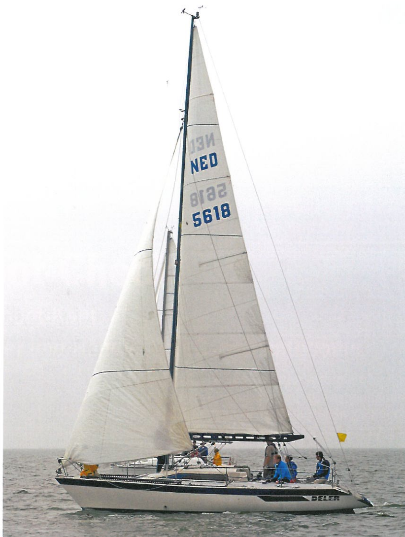
Zu Zeiten der IOR-Vermessungsformel setzte sich das sehr flexible 7/8-Rigg durch. Dabei wurde mit immer dünneren Mastprofilen experimentiert, die über zahlreiche Salingpaare und Backstagen verfügten.
