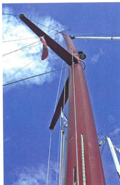
Frühes 7/8-Rigg mit gefeilten Salingen. Der Vorstagszug wird zum großen Teil über die Oberwanten erzeugt.
