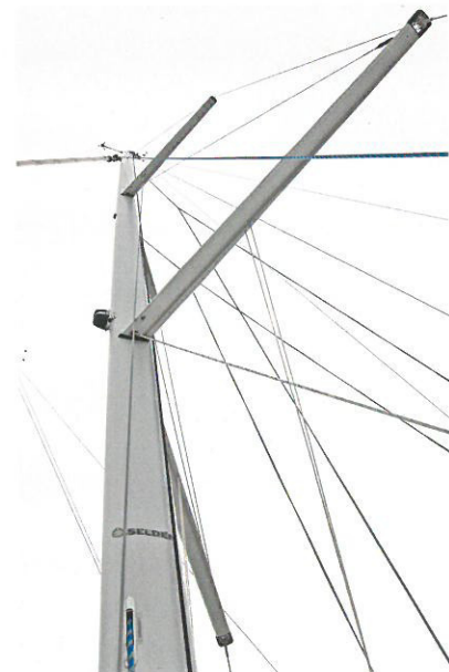
Moderne 9/10-Rigg mit starker Pfeilung. Eine effektive Mastkrümmung ist kaum möglich.
