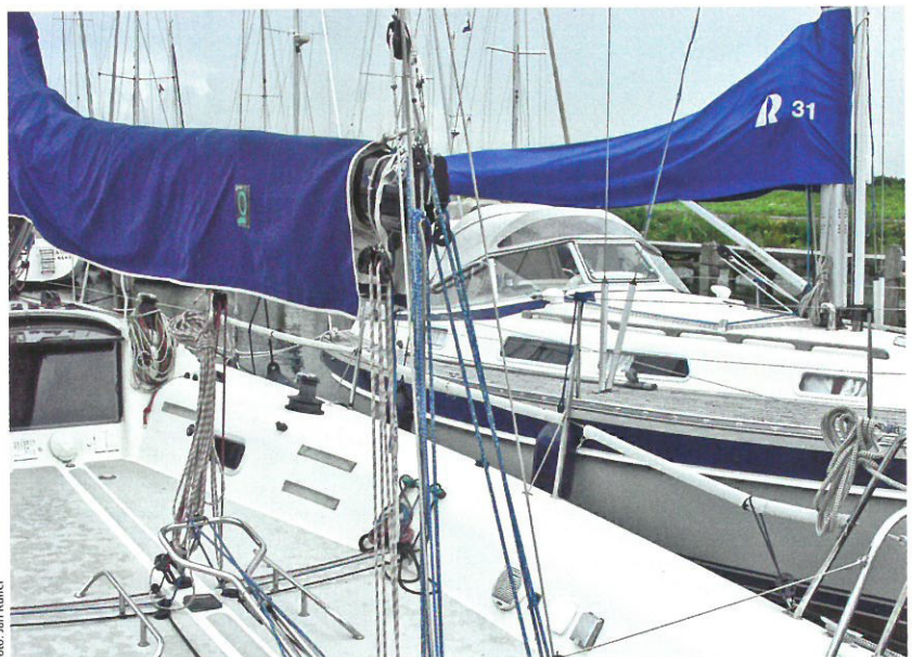
Kaskaden-Anordnung für den Achterstagspanner. Auch auf modernen Racern wird das Achterstag als aktives Trimminstrument genutzt.
