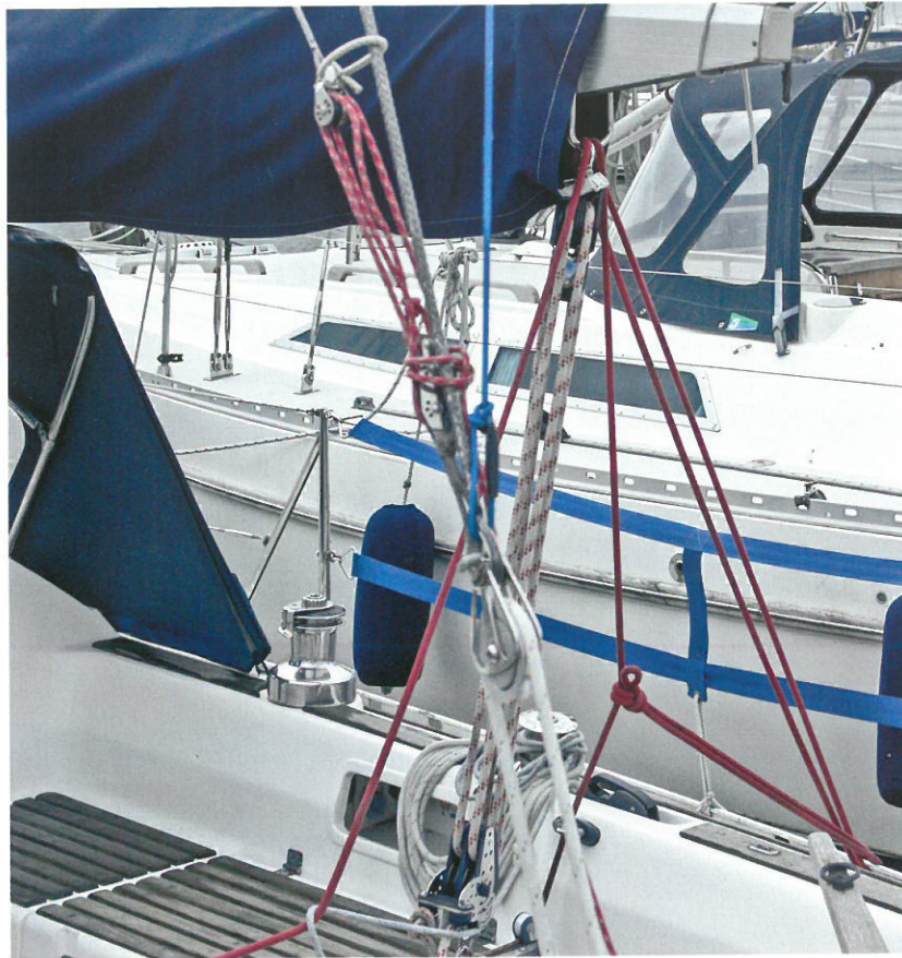
Backstag- und Checkstag-Arrangement eines klassischen 7/8-Riggs ohne Salingpfeilung. Die Checkstagen kontrollieren die Mastkurve im unteren Bereich.
