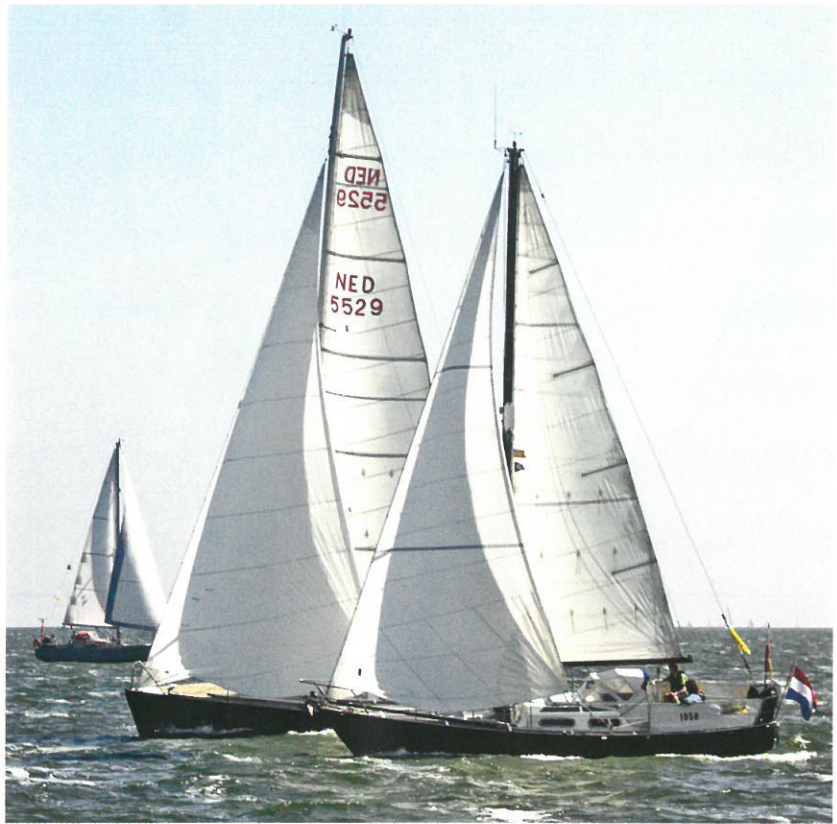
Das klassische Fahrten-Topprigg lässt sich derweil nur in begrenztem Umfang biegen. Das Profil wird durch vordere und achtere Unterwanten fixiert.
