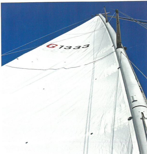
Diagonalfalten bedeuten zu viel Mastbiegung für den Großsegelschnitt, der Mast ist übertrimmt.
