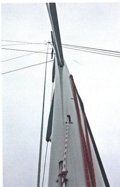
Auch Toppriggs können flexibel konzipiert werden, hier kontrollieren doppelte Checkstagen die Mastkurve.
